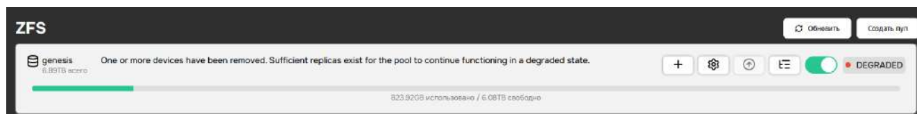
Рисунок 110 – Пул в состоянии «DEGRADED»
